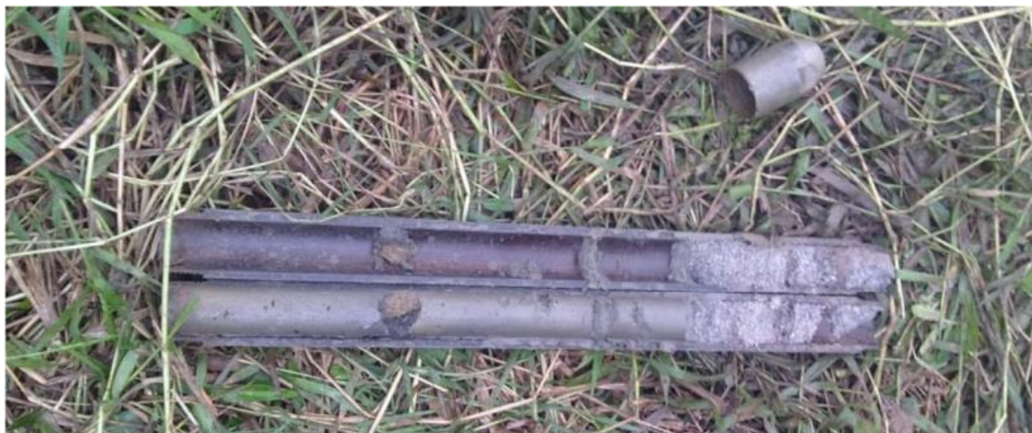
Figura 7 – Solo Areia – Argilo – Siltosa recuperado pelo amostrador , abaixo do nível do rio
