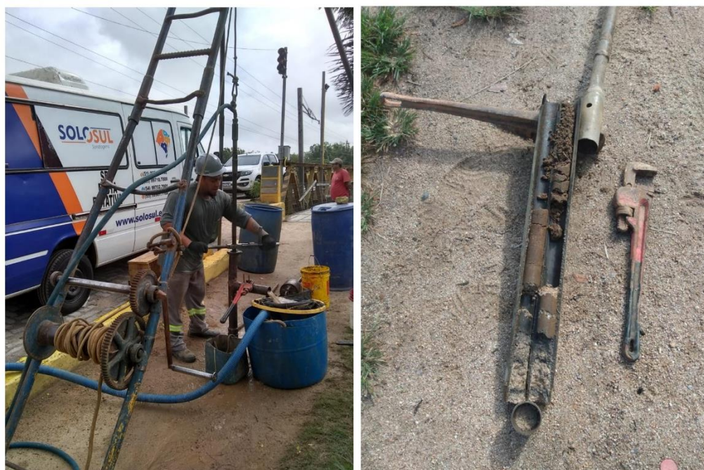
Figura 4 – Montagem do equipamento e detalha da amostra do solo – SPT-02
