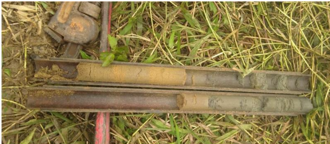
Figura 6 – Solo Areia – Argilo – Siltoso recuperado pelo amostrador , acima do nível do rio
