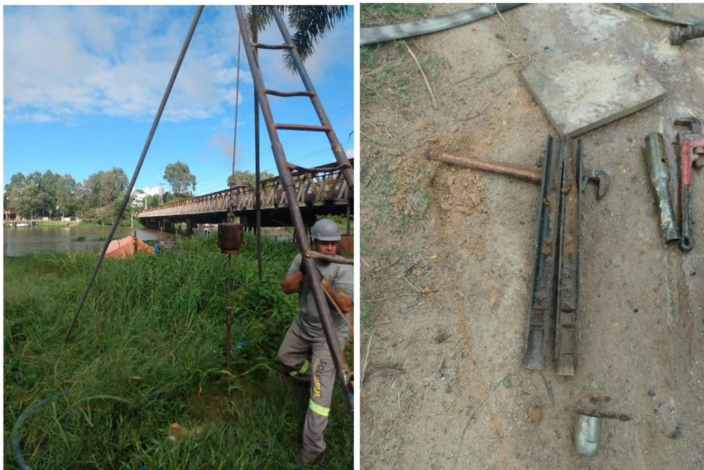
Figura 3 – Montagem do equipamento e detalha da amostra do solo – SPT01
