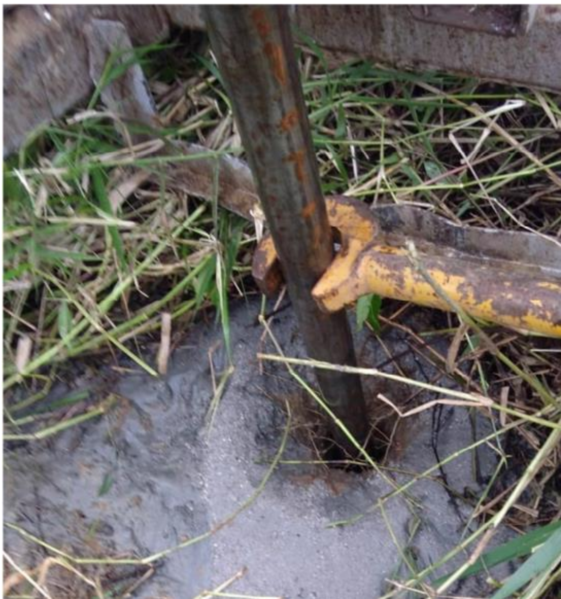
Figura 8 – No detalhe, resíduo da rocha (basáltica / diorítica – sã) resultante do corte e avanço da sonda rotativa.
