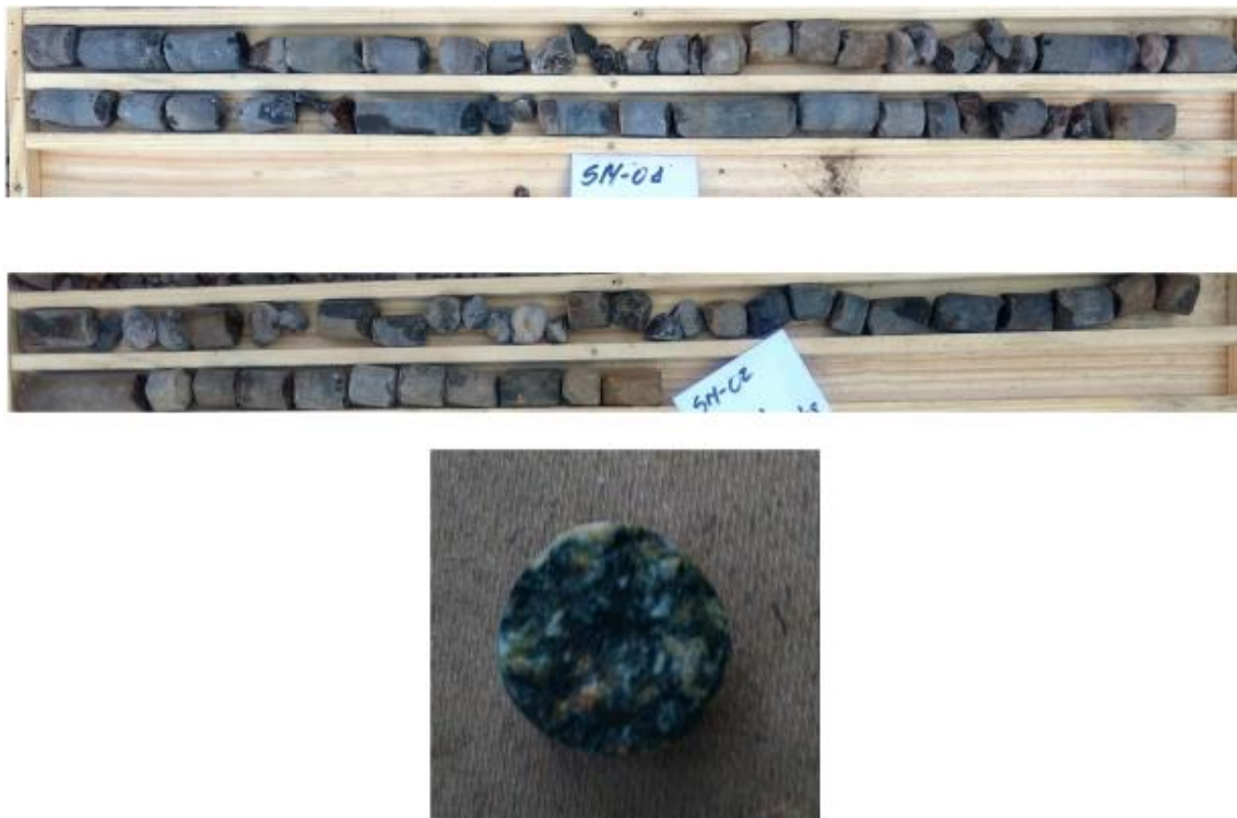
Figura 9 – No detalhe, caixa com testemunhos extraídos pela sondagem rotativa.
